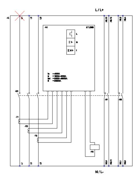
L (Long Time Delay / Oberlastschuts); S (Moort Time Delay / Enrachlussschuts, burschiversügert); I (Instantanaous / Enrachlussachuts, uncersügert); FS (Englatch für trip unit / Amaldesungmet); 81 - 88 (Auxiliary switch / Hilfsechalter);
