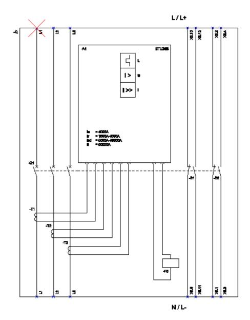
L (Long Time Delay / Oberlastschuts); S (Short Fine Delay / Enrachlussschuts, burszeitversügert); I (Instantanacus / Enrachlussschuts, unverzügert); FS (Beglatch für trip unit / Amalössungset); S1 - S3 (Auxiliary switch / Hilfsschalter);
