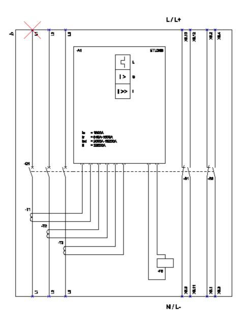
L (Long Time Delay / Disclastichets); S (Nort Time Delay / Enrichlussichets, Eursteltwersügert); I (Instantanzons / Enrichlussichets, unverzögert); FS (Engleich für trip unit / Amaléeungeet); S1 - S8 (Anxiliary writch / Eilfeschalter);
