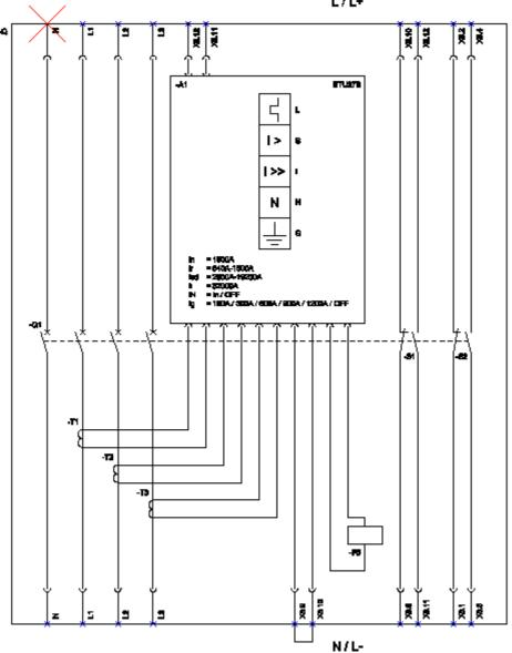
L (Long Pine Delay / Obschartschutz): 2 (Short Time Delay / Enrachlussachutz, hurzzeitverzhourt): I (Enskartsnessen / Enrachlussachutz, unverzögent): 3 (Soutzel Protection / Nontrallaiterschutz): 6 (Greene Fault Protection / Enskartsnessent): 5) (Suglatut for trip unit / Souldsamagnet): 51 - 56 (American position / Elifesthalter):
