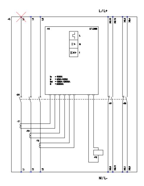
L (Long Time Delay / Oberlastschuts); S (Moort Time Delay / Enrachlussschuts, burschiversügert); I (Instantanaens / Enrachlussachuts, uncersügert); FS (Englatch for trip unit / Amaléssanguet); 81 - 88 (Auxiliary switch / Hilfsechalter);
