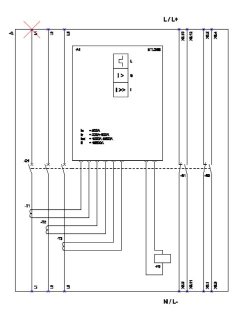
L (Long Time Delay / Disclastichets); S (Most Time Delay / Enrichlussichets, Eurschlussichets); I (Instantanzons / Enrichlussichets, unverzögert); FS (Engleich für trip unit / Amalésimgest); S1 - S8 (Anxiliary writch / Bilfeschalter);
