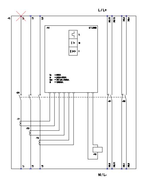
L (Long Time Delay / Oberlastschuts); S (Moort Time Delay / Enrachlussschuts, burschiversügert); I (Instantanaens / Enrachlussachuts, uncersügert); FS (Englatch für trip unit / Amaldesungmet); 81 - 88 (Auxiliary switch / Hilfsechalter);
