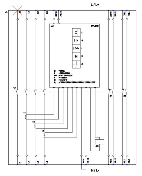
L (Long Fine Delay / Confinetectory) & (Short Time Delay / Enryschlussechnix, Enryseitversbyert)) I (Enstantaneous / Enryschlumentory, unversögert)) % (Soutcal Protoction / Wentrallaiterschutz), 8 (Branni Fuelt Protoction / Enschlussechniz)) F5 (Englatet for trip unit / Bealdonneport): 81 - 88 (Amiliary switch / Bilfsschulter);
